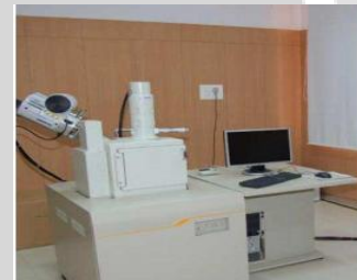
Figure 4. SEM Set up
