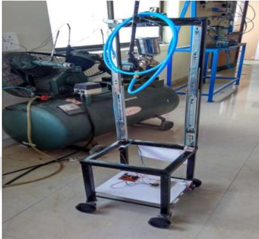
Fig 2.2 Actual wall painting robot
