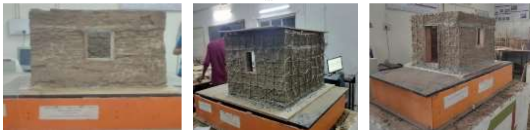
Fig.-5 Model A1, A2 and A3 on shake table
