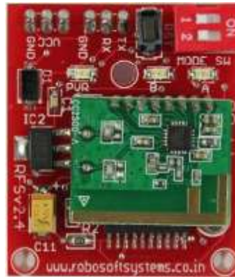
Fig 3.1(a). CC2500 RF module
