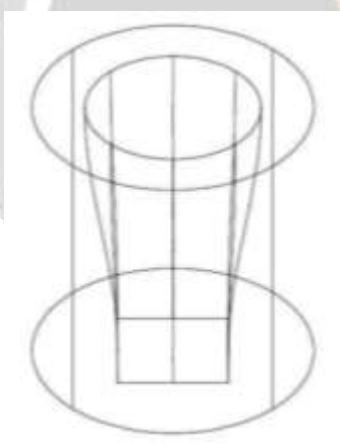
**Fig. wire-frame model**
