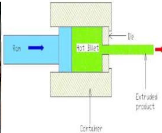
Fig.3.2 Extrusion die
