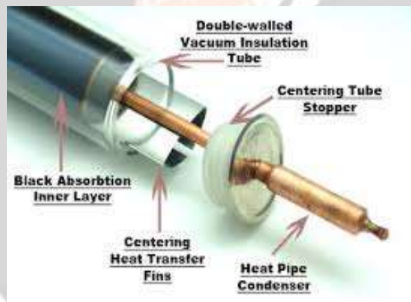
Fig. 2 Actual Evacuated Tube Heat Pipe
