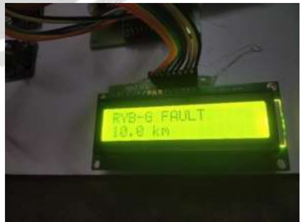
Fig -7: LLL-G Fault
