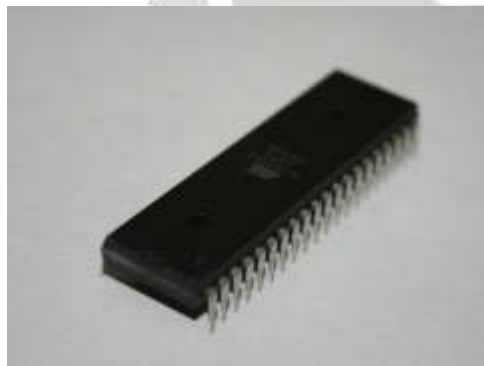
Fig 4.6.1: Actual diagram of Microcontroller 89S52
