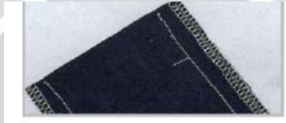
Fig No: 18. Uneven stitch Density
