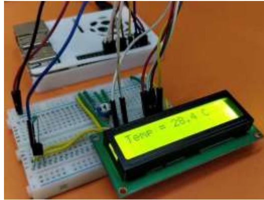
Fig. 9 sensors values displayed on LCD.
