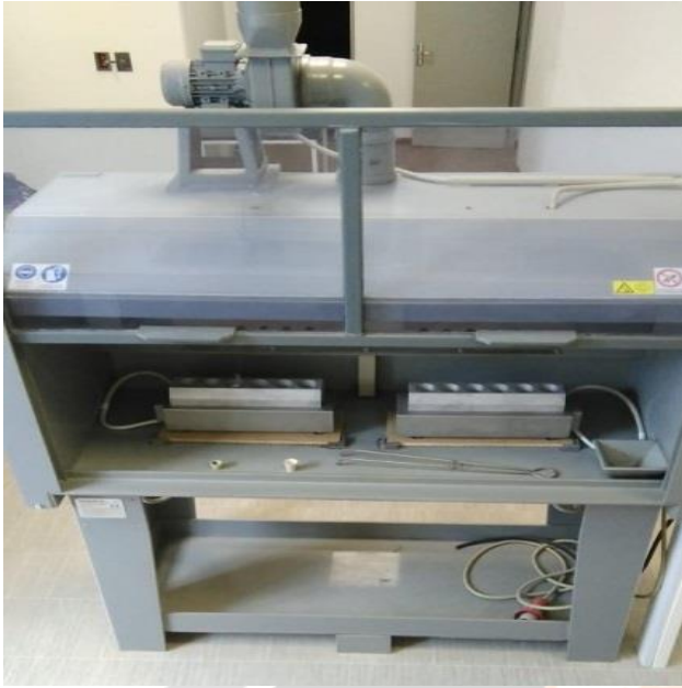
Photos 6: Hotte de séparation Source : Auteur
