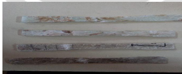
Fig.3 Tensile test specimen
