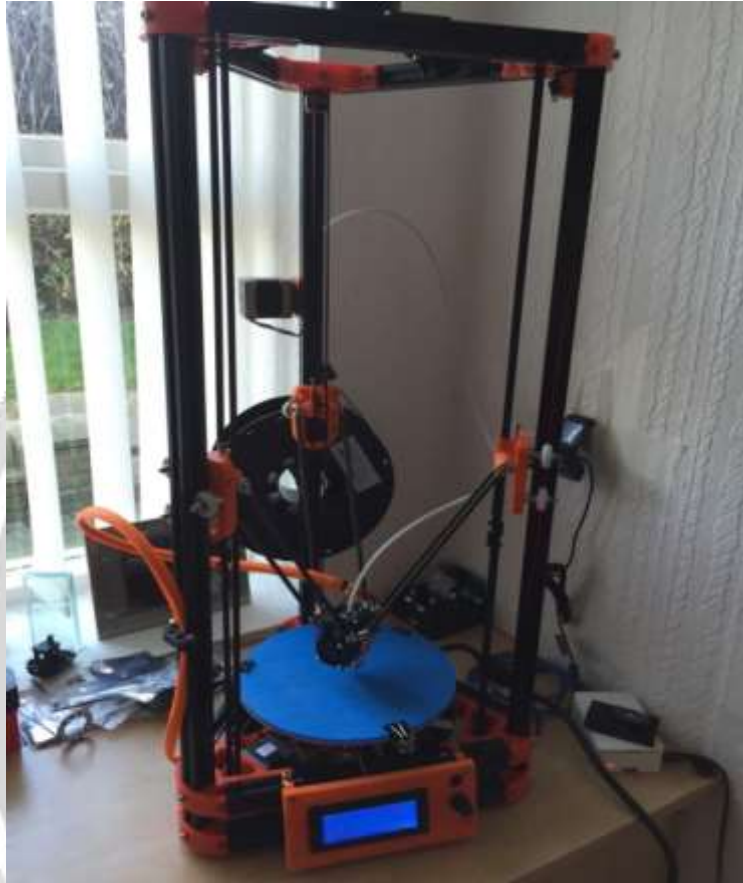
Figure 3 Experimental Unit (Kossel Mini Delta 3D Printer Machine)[18]
