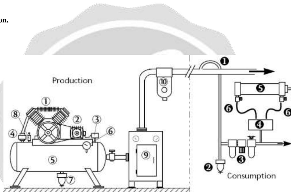
Fig. 4.1 Basic Pneumatic System.
