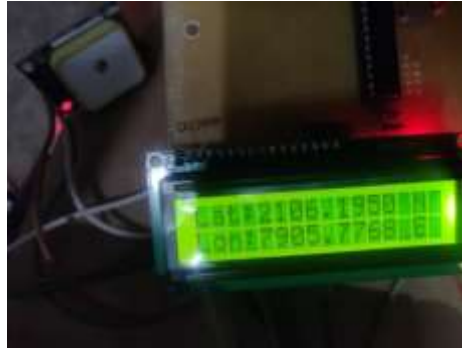
Fig-9: LCD display showing latitude and longitude values
