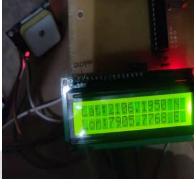
Fig-6: LCD Showing Latitude and Longitude
