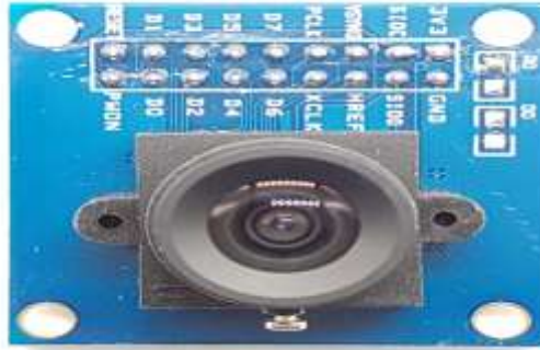
Fig-6 :OV 7670 Camera Module
